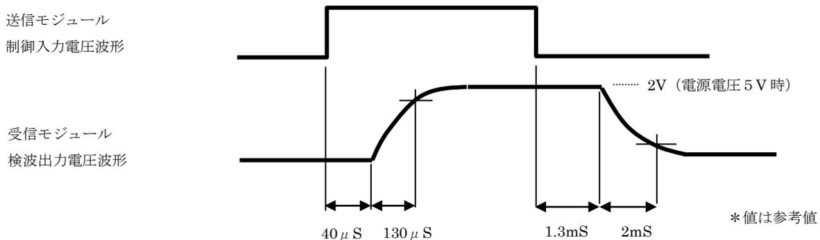
反射波で距離計算を行う時は、立ち上がりで $40\mu\text{s}$ の遅れが発生しますので、時間計測では、その分を差し引いた計算が必要です。
